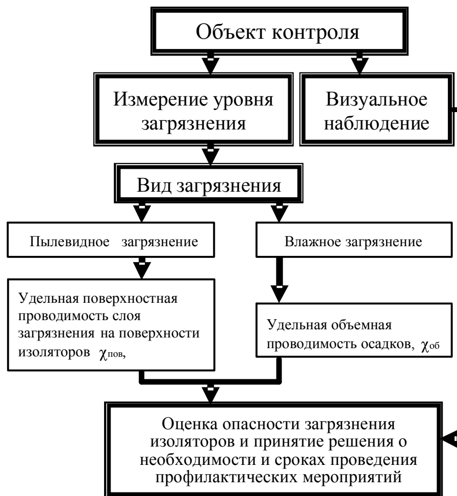
Рисунок 2 - Структура контроля состояния изоляции в процессе эксплуатации
