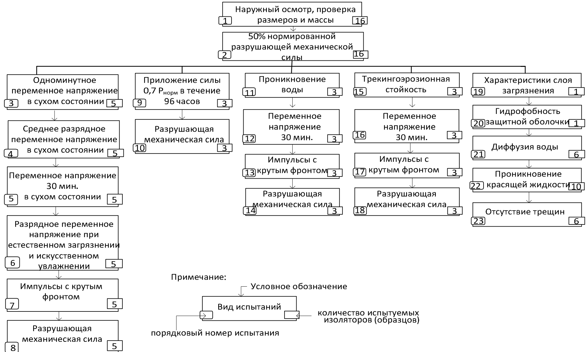
Рисунок Ж2 - Схема проведения испытаний подвесных полимерных изоляторов после 6 лет эксплуатации
