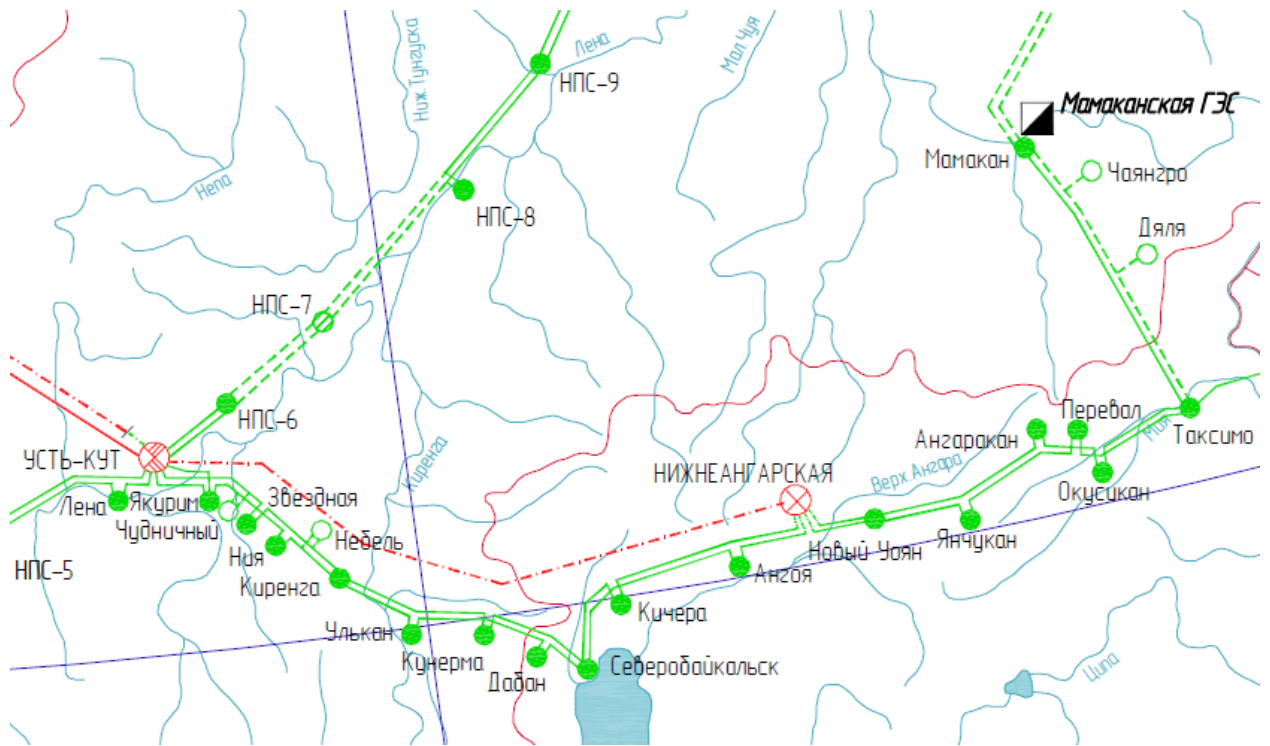
Рисунок 1 – Схема сети 220 кВ и выше района расположения объекта
